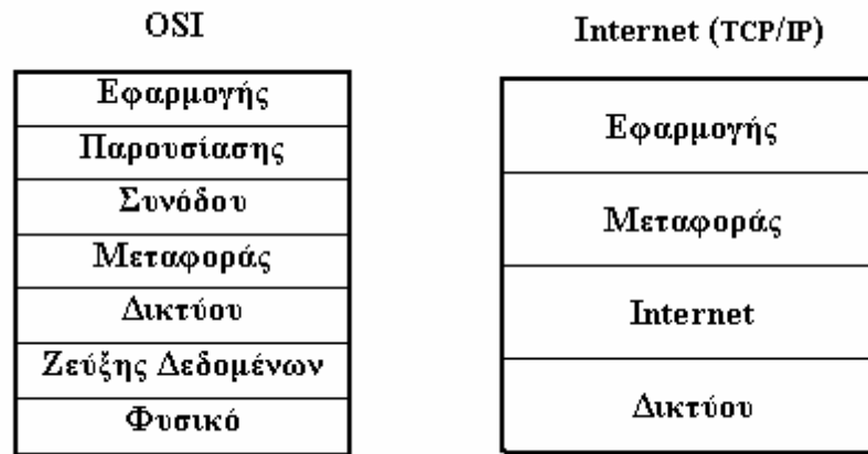
Εικόνα 1. Τα επίπεδα του μοντέλου OSI και η σχέση τους με τα επίπεδα του απλουστευμένου) TCP/IP μοντέλου
