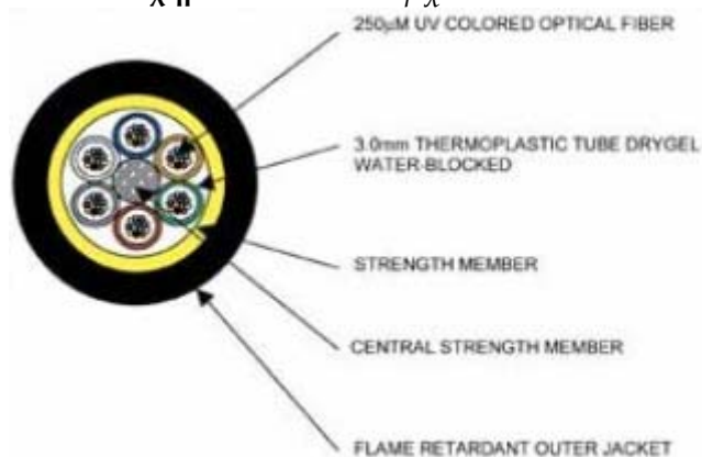
Σχήμα 3.5. Καλώδιο σφιχτού πακέτου.
