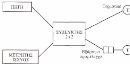
Σχήμα 12.5. Ειδική εγκατάσταση μέτρηση της επιστρεφόμενης ανάκλασης
