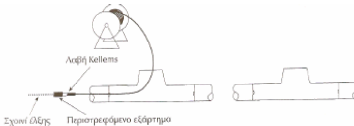
Σχήμα 9.3. Το πρώτο ήμισυ μίας διαδικασίας τραβήγματος πολλών σταδίων.
