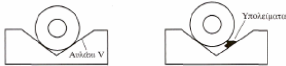
Σχήμα 5.7 Η μέθοδος αυλακιών V εναπόθεσης της οπτικής ίνας
