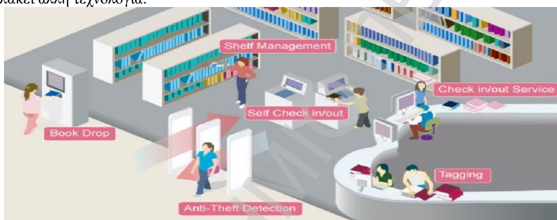
Εικόνα 19 Απεικόνιση της λειτουργίας μιας βιβλιοθήκης βάσει συστήματος RFID
