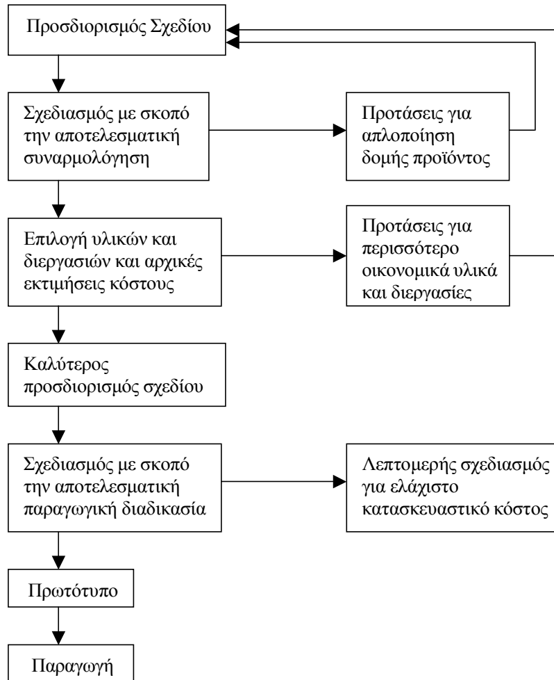
Σχήμα 2.10. Διαδικασία concurrent engineering χρησιμοποιώντας τεχνικές DFMA (Boothroyd G., Dewhurst P., Knight W., 1994).
