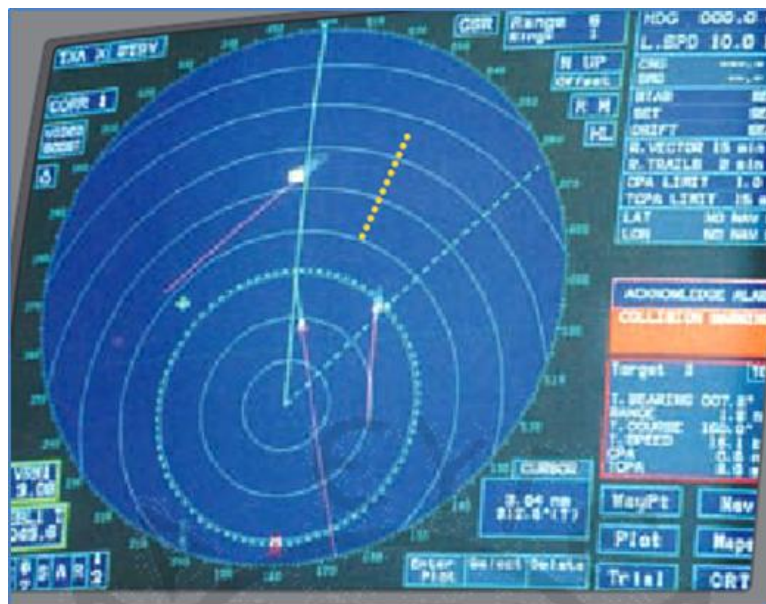
Εικόνα 25: Επαναλήπτης radar με ενεργοποιημένο SART (πηγή Ταμπακάκης, 2017)
