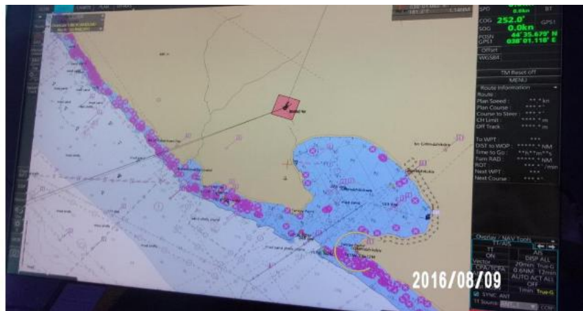
Εικόνα 35 : Λανθασμένη απεικόνιση θέση πλοίου στο ECDIS (Πηγή http://shipsbusiness.com/ECDIS-warning.html )
