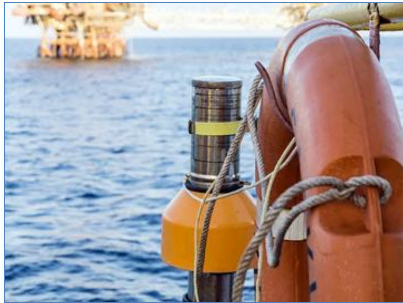
Εικόνα 8 : EPIRB τοποθετημένο στην βαρδιόλα πλοίου (πηγή https://www.marineinsight.com/marine-safety/what-is-epirb-emergency-position-indicating-radio-beacon/ )
