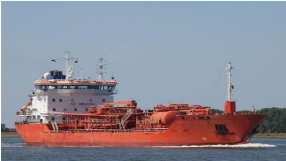
Παράσταση 4.35: Πλοίο μεταφοράς χημικού φορτίου. Στα πλοία αυτής της κατηγορίας εύκολα διακρίνει κανείς το δίκτυο δεξαμενών και σωληνώσεων.
