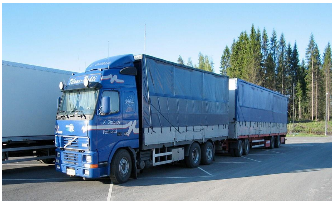
Παράσταση 4.3: Ρμουλκό μετά ρμουλκούμενου (συρμός). Όχημα μεγαλύτερης χωρητικότητας από το ημι-ρμουλκούμενο.
