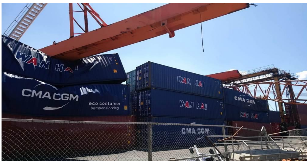
Παράσταση 7.4 :Κατάρρευση γερανού με αποτέλεσμα την καταστροφή φορτίων και απώλεια ζωής. (πηγή: Taiwan English News)
