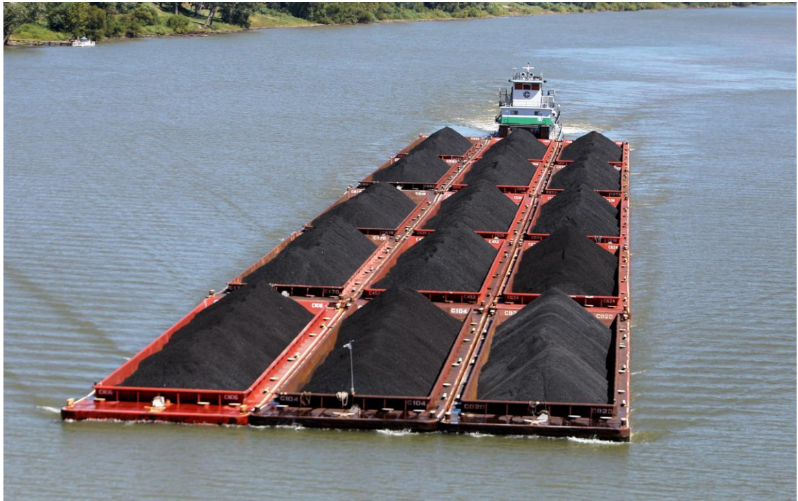
Παράσταση 4.45: Φορηγίδα μεταφοράς άνθρακα στον ποταμό Οχάιο στις ΗΠΑ. Η συγκεκριμένη φορηγίδα όπως και η φορηγίδα στην παράσταση 4.46 δεν είναι αυτοκινούμενες παρά κινούνται με τη βοήθεια ρυμουλκού.
