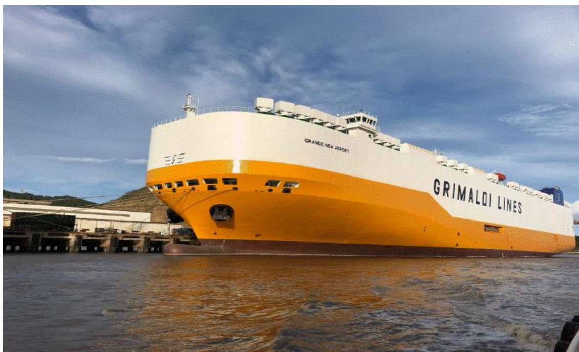
Παράσταση 4.32: Πλοίο μεταφοράς οχημάτων RoRo [Roll-on/roll-off]. Στα πλοία μεταφοράς RoRo τα φορτία προς μεταφορά δε μεταφέρονται με γερανούς αλλά εισέρχονται με τις ρόδες ή τις ερπίστριες τους στο εσωτερικό του πλοίου.
