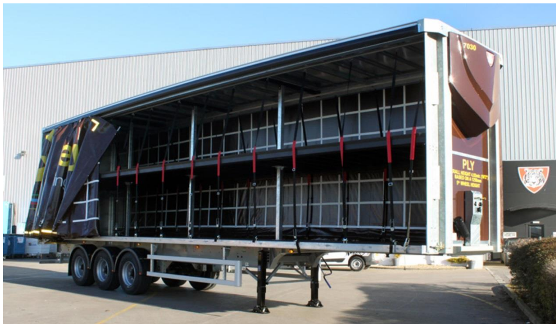
Παράσταση 4.10: Ένα ρυμουλκούμενο Double deck. Είναι ρυμουλκούμενο μεγαλύτερης χωρητικότητας με διπλό πατάρι φόρτωσης για στοιβάσια περισσότερων παλετών.
