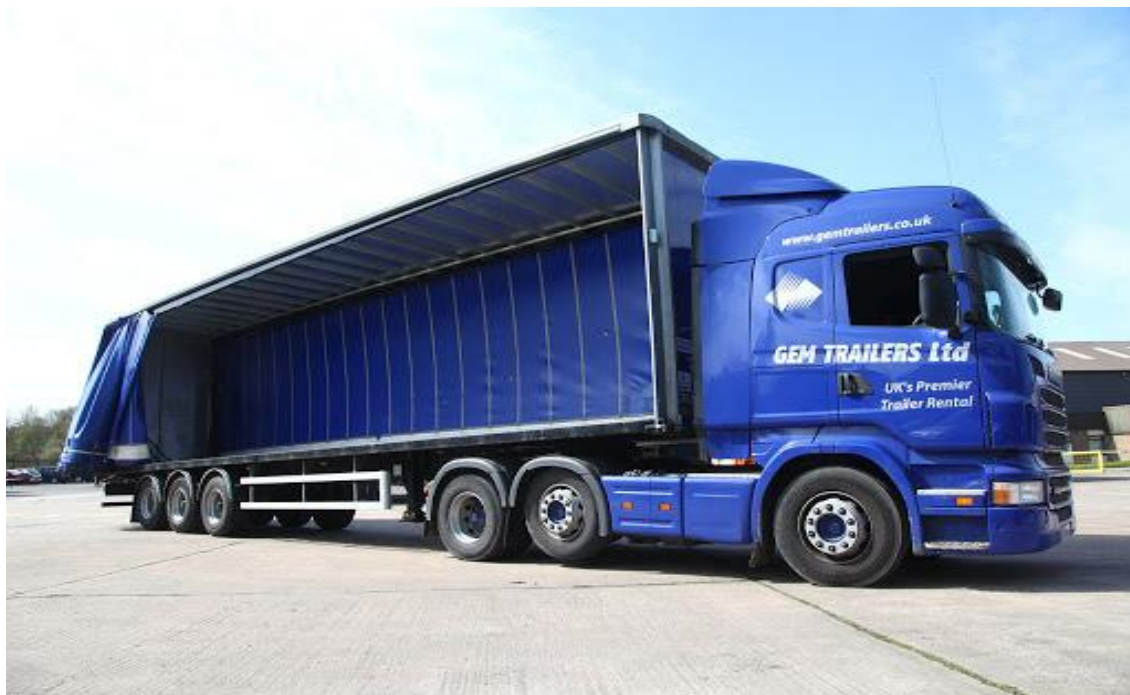
Παράσταση 4.2: Ημι-ρμουλκούμενο φορτηγό με σύστημα κουρτίνας-συρόμενου μουσαμά. Ο συγκεκριμένος τύπος ρμουλκούμενου χρησιμοποιείται για μεταφορά συσκευασμένου φορτίου σε παλέτες.
