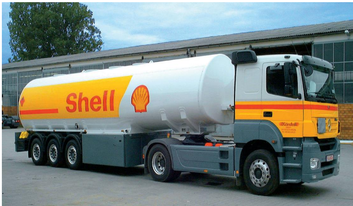
Παράσταση 4.8: Φορητό ημι-ρυμουλκούμενο βυτιοφόρο μεταφοράς υγρών καυσίμων.
