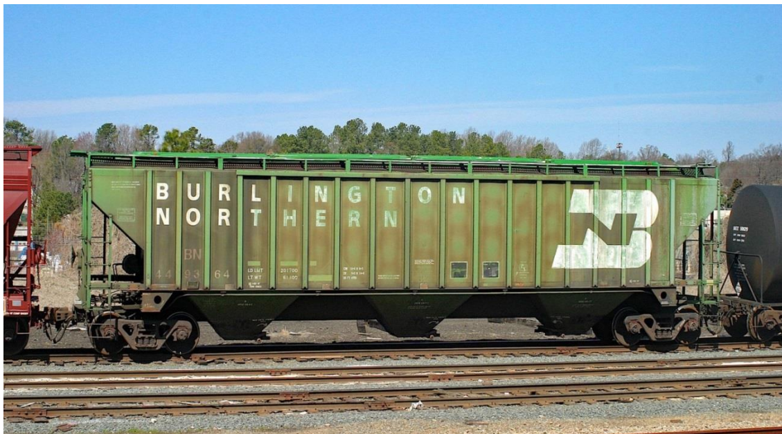
Παράσταση 4.21: Βαγόνι ανοιχτής χοάνης. Τέτοιου είδους βαγόνια χρησιμοποιούνται για μεταφορά χύδην προϊόντων, που όμως κινδυνεύουν από υγρασία, βροχές κ.ά. (σιτηρά, δημητριακά κ.ο.κ.).
