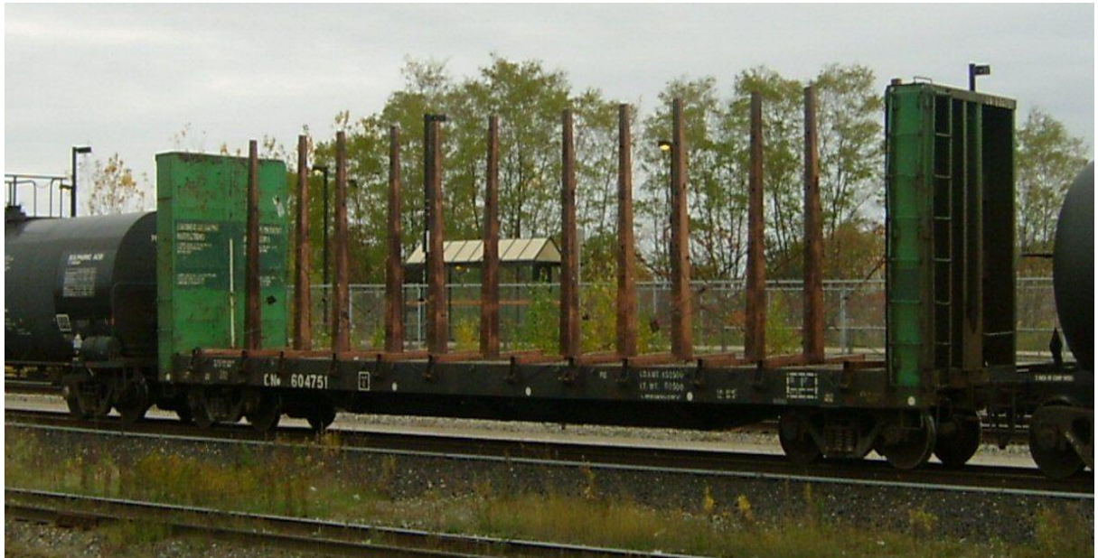
Παράσταση 4.22: Βαγόνι πλατφόρμα. Ενδείκνυται για μεταφορά βαρέων φορτίων μεγάλου μήκους και όγκου αλλά και project/heavy lift cargo.
