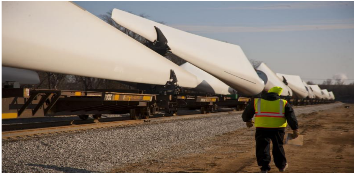
Παράσταση 4.25:Βορειοαμερικανικό σιδηροδρομικό βαγόνι πλατφόρμα μεταφοράς ανεμογεννητριών ιδιοκτησίας της Union Pacific*.
