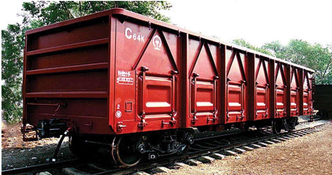
Παράσταση 4.20: Βαγόνι ανοικτής οροφής. Ο συγκεκριμένος τύπος οχημάτων χρησιμοποιείται για τη μεταφορά μη μοναδοποιημένων χύδην φορτίων:
