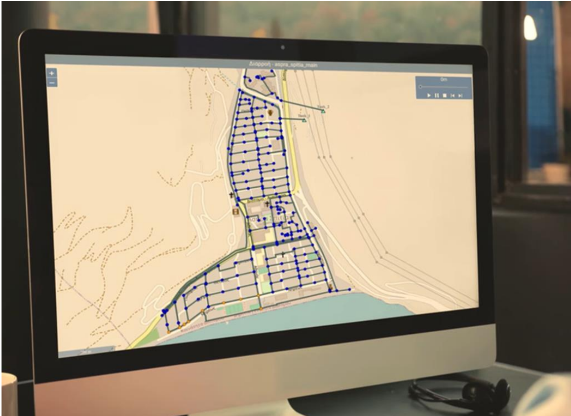
Εικόνα 36: Ψηφιακή χαρτογράφηση και μοντελοποίηση του δικτύου ύδρευσης.
