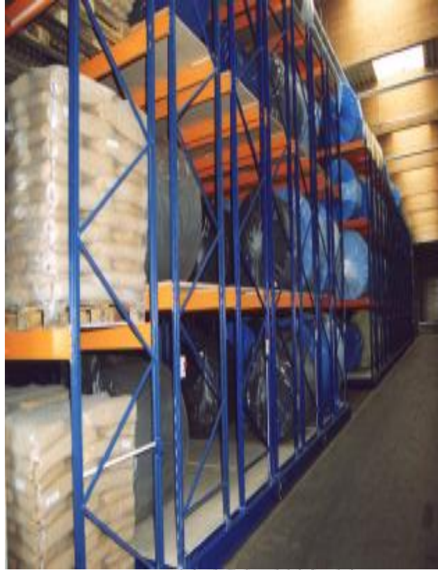
Σχήμα 19: Κυλιόμενα ράφια παλέτας. Διακρίνεται ο διάδρομος λειτουργίας που έχει δημιουργηθεί (δεξιά στη φωτογραφία)
