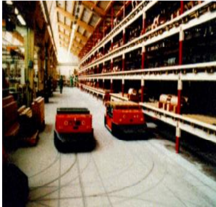
Σχήμα 32: AGV σε λειτουργία. Διακρίνονται οι τροχιές τους στο δάπεδο της αποθήκης
