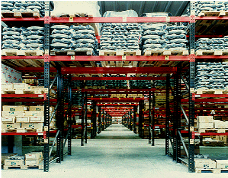
Σχήμα 10: Δημιουργία «γέφυρας» σε ράφια back to back για να διέρχονται τα περονοφόρα. Εδώ έχουν αφαιρεθεί οι δοκίδες από το 1ο και το 2 καθ' ύψος επίπεδο.
