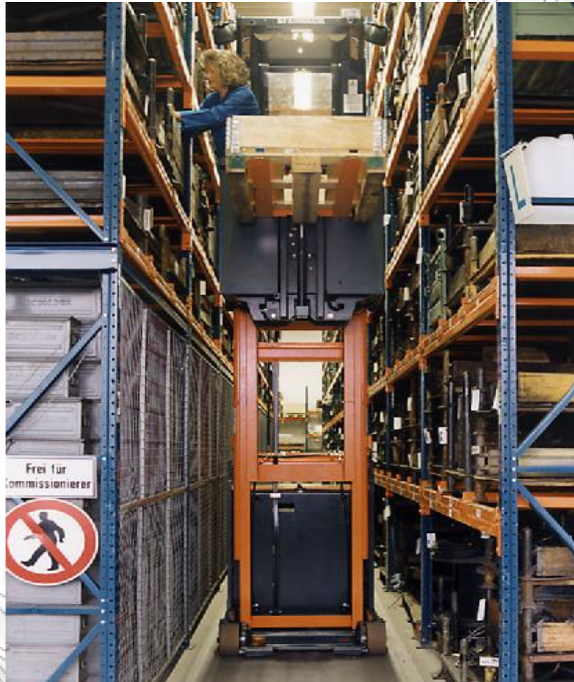
Σχήμα 29: Περονοφόρο τύπου order picker μεγάλου ύψους
