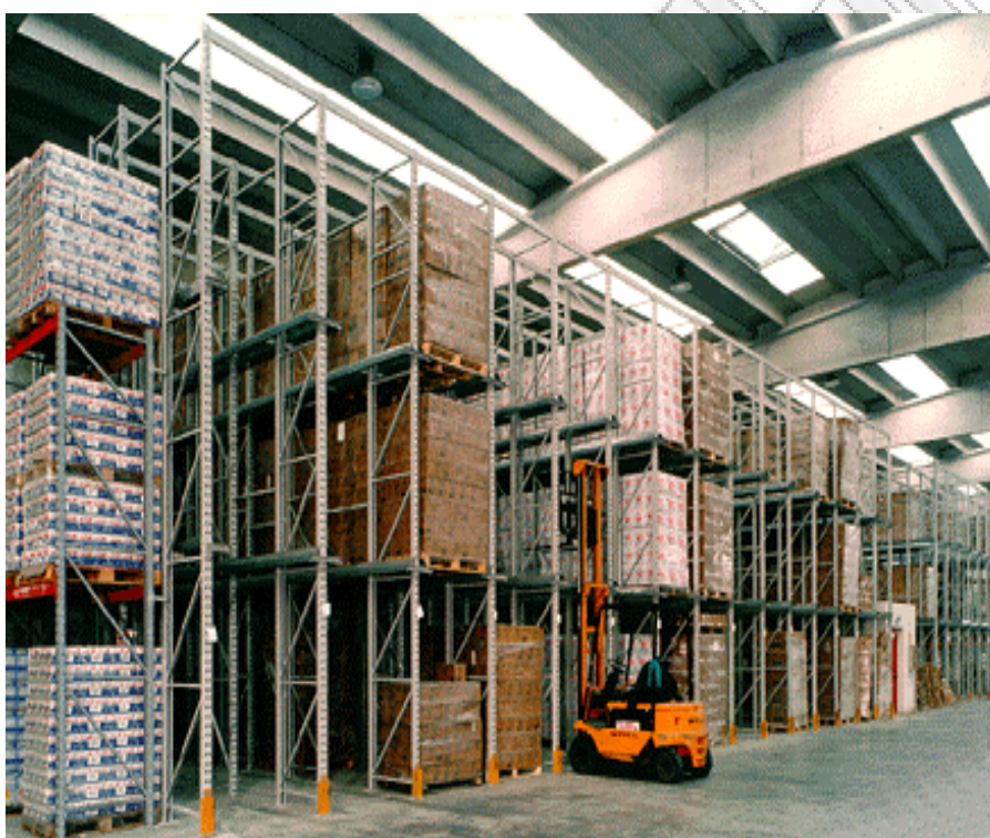
Σχήμα 14: Ράφια Drive In. Το ανυψωτικό κινείται ανάμεσα στα φατνώματα των ραφιών
