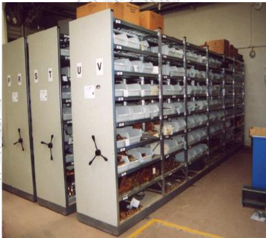
Σχήμα 20: Κυλιόμενα ράφια θυρίδας με χειροκίνητο μηχανισμό μετακίνησης
