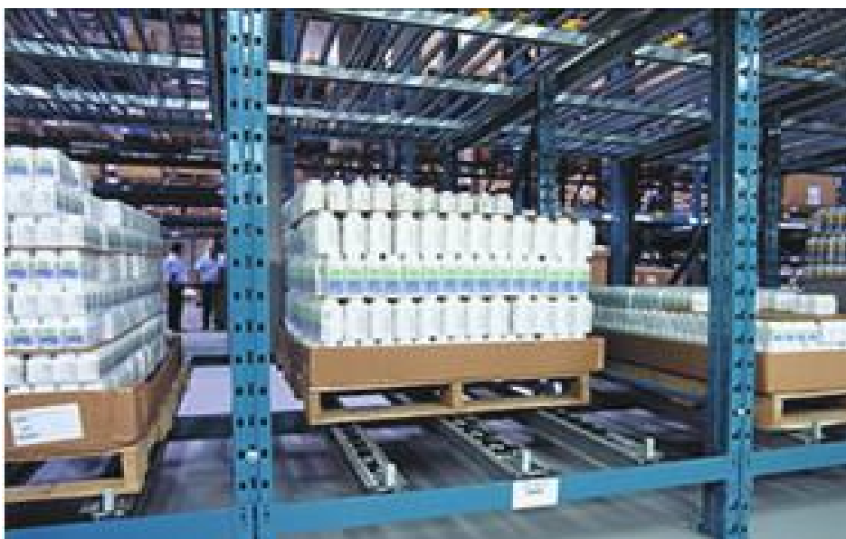
Σχήμα 16: Ράφια Live Storage. Όψη από το σημείο τοποθέτησης παλετών. Διακρίνονται οι μεταφορικοί μηχανισμοί βαρύτητας μεταφοράς των παλετών
