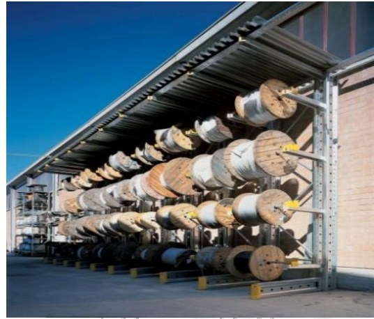
Σχήμα 18: Ράφια με προβόλους για αποθήκευση σάλινγων και στροφείων
