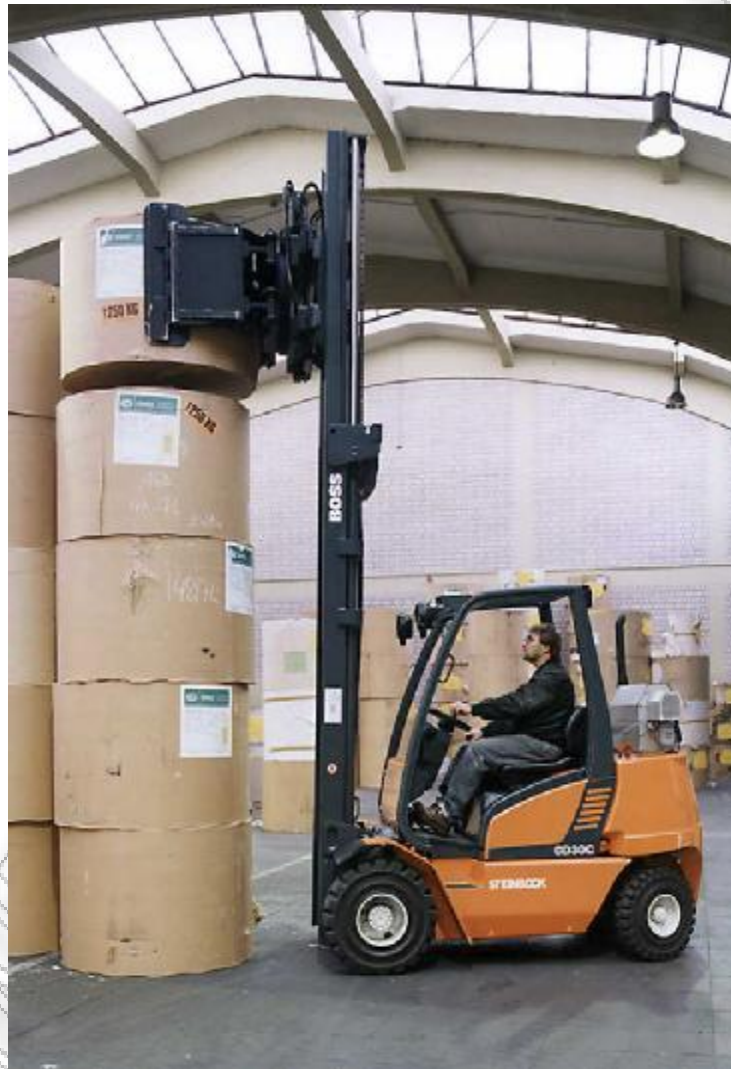
Σχήμα 25: Περονοφόρο counterbalance εξοπλισμένο με δαγκάνες για διακίνηση ρολών χαρτιού
