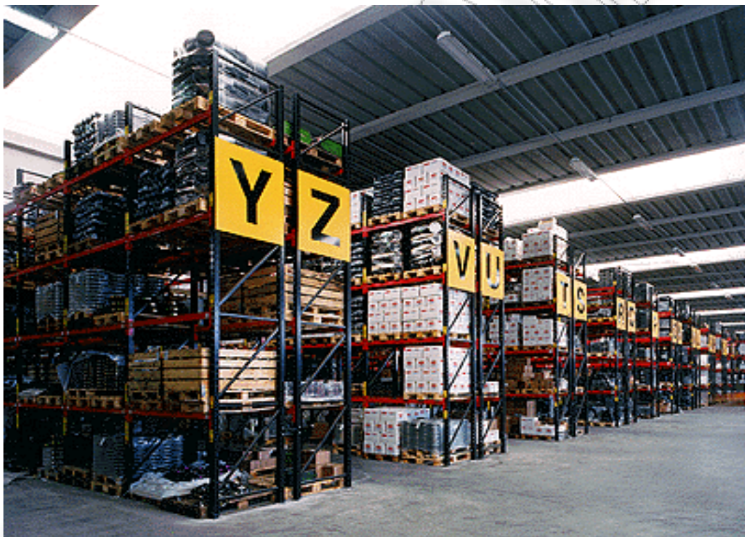
Σχήμα 11: Κλασικά ράφια παλέτας back to back. Διακρίνεται και η κωδικοποίηση των ραφιών
