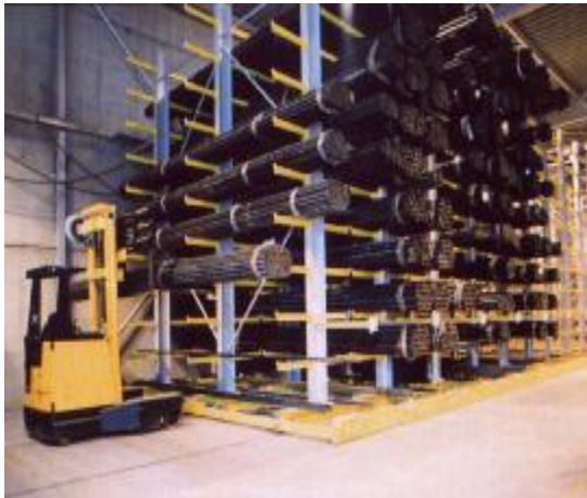
Σχήμα 18: Ράφια με προβόλους για αποθήκευση σάλινγων και στροφείων
