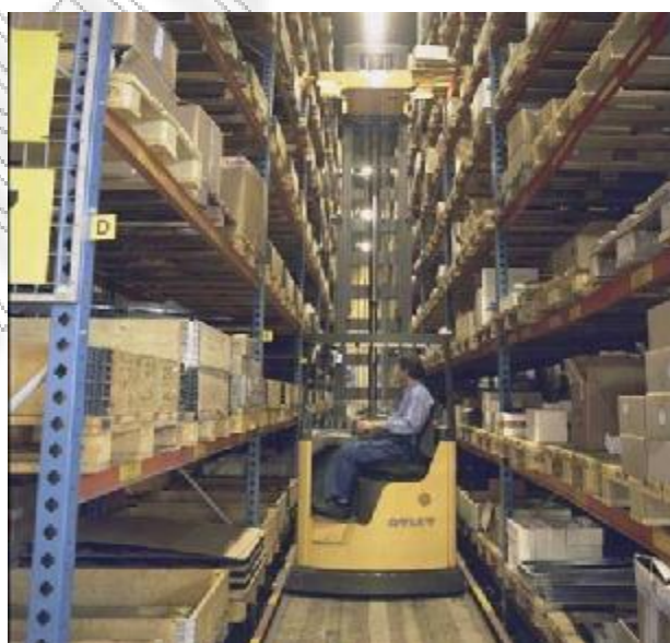
Σχήμα 28: Περονοφόρο στενών διαδρόμων. Ο οδηγός κάθεται σε θέση «κάβουρα», δηλαδή κάθετα στη φορά κίνησης του περονοφόρου
