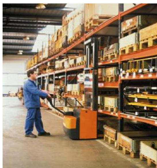
Σχήμα 24: Χειροκίνητο παλετοφόρο πεζού χειριστή, με ιστό ανύψωσης
