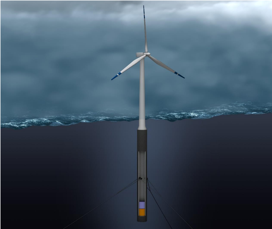
Εικόνα 4.8 Δοκός – Πλωτήρας (Spar Buoy)
