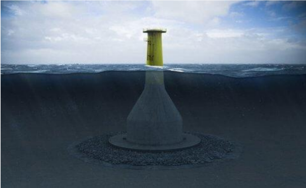
Εικόνα 4.5 Βάση (θεμέλιο) βαρύτητας σκυροδέματος
