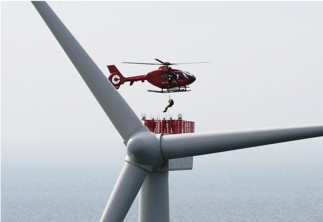
Εικόνα 4.10 Προσέγγιση σε υπεράκτια ανεμογεννήτρια με ελικόπτερο
