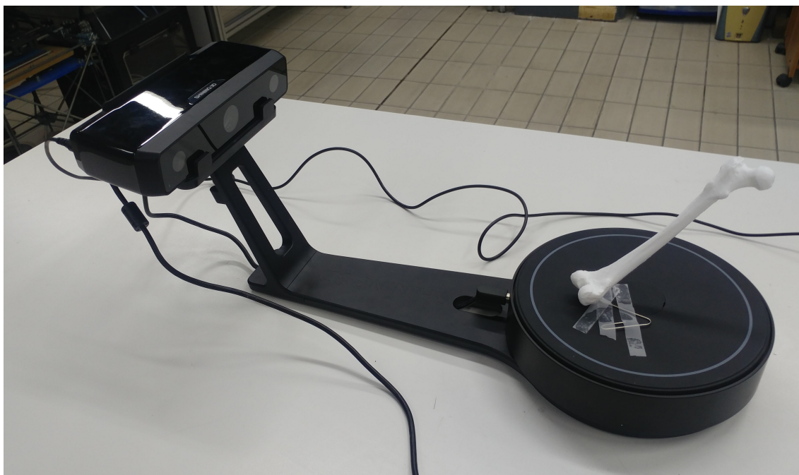
Σχήμα 4.6: Τοποθέτηση και σταθεροποίηση του μηριαίου οστού στο δίσκο περιστροφής του Einscan SE
