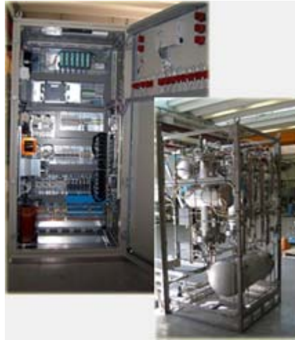
Εικόνα 16: Μονάδες παραγωγής υδρογόνου από την ηλεκτρόλυση του νερού
