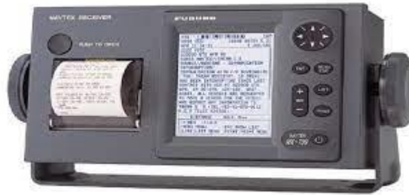
Εικόνα 45 - Συσκευή NAVTEX στη γέφυρα πλοίου
