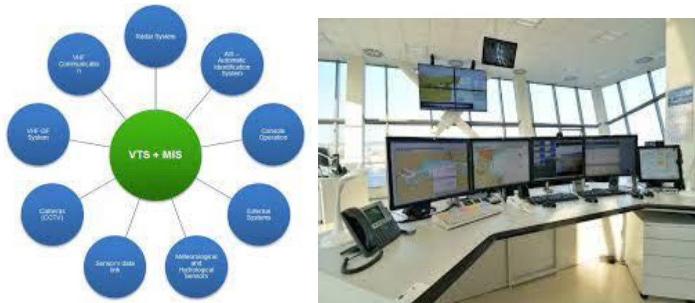
Εικόνα 65 – Διασυνδέσεις και κέντρο επιχειρήσεων συστήματος VTMS
