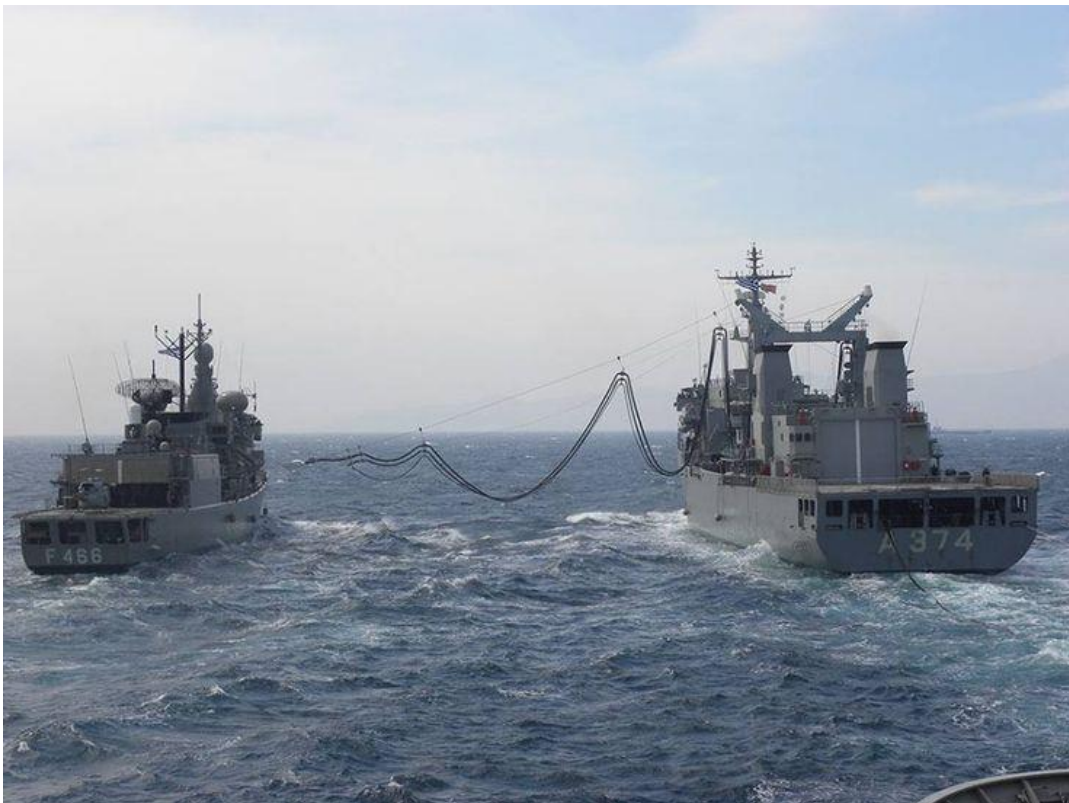
Εικόνα 5.1: Πετρέλευση εν πλω
