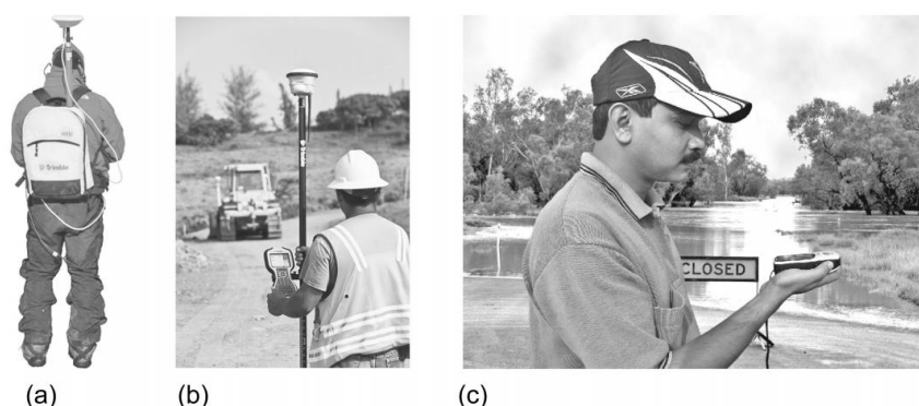
Εικόνα 2 : (a) Έρευνα RTK με κεραία τοποθετημένη στο σακίδιο. (b) Έρευνα RTK με κεραία τοποθετημένη στον πόλο. (c) Τοποθέτηση με φορητό αυτόνομο δέκτη κωδικού.
