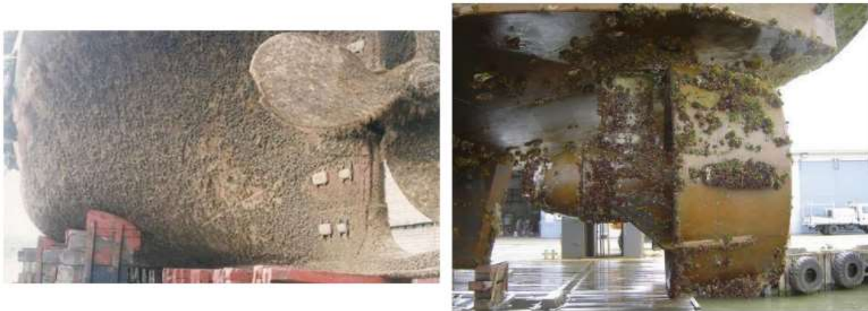
Σχήμα 3.4: Βιοσυσσώρευση στη γάστρα και στα ύφαλα πλοίου.
