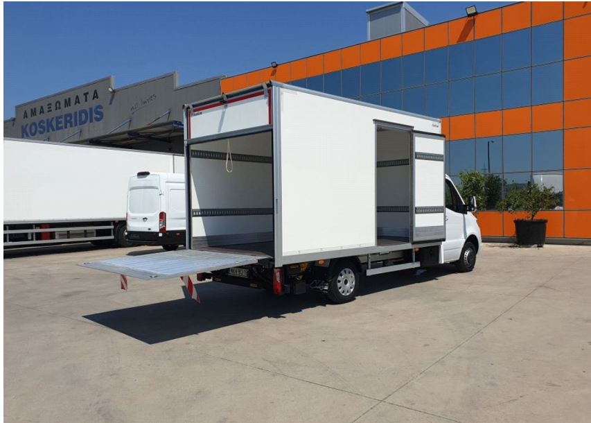
Εικόνα 11: Ισοθερμική κιβωτάμαξα (Stringer and Dennis, 2000).
