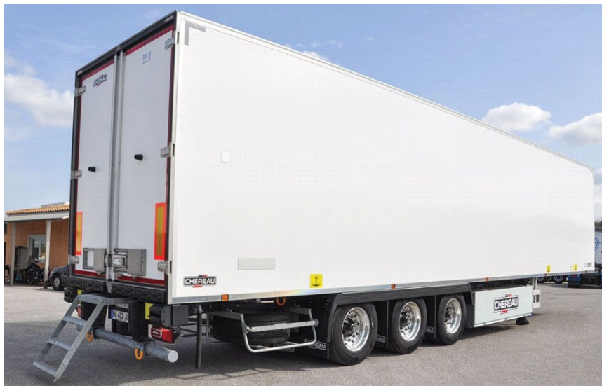
Εικόνα 12: Παράδειγμα ψυκτικού θαλάμου (Stringer and Dennis, 2000).
