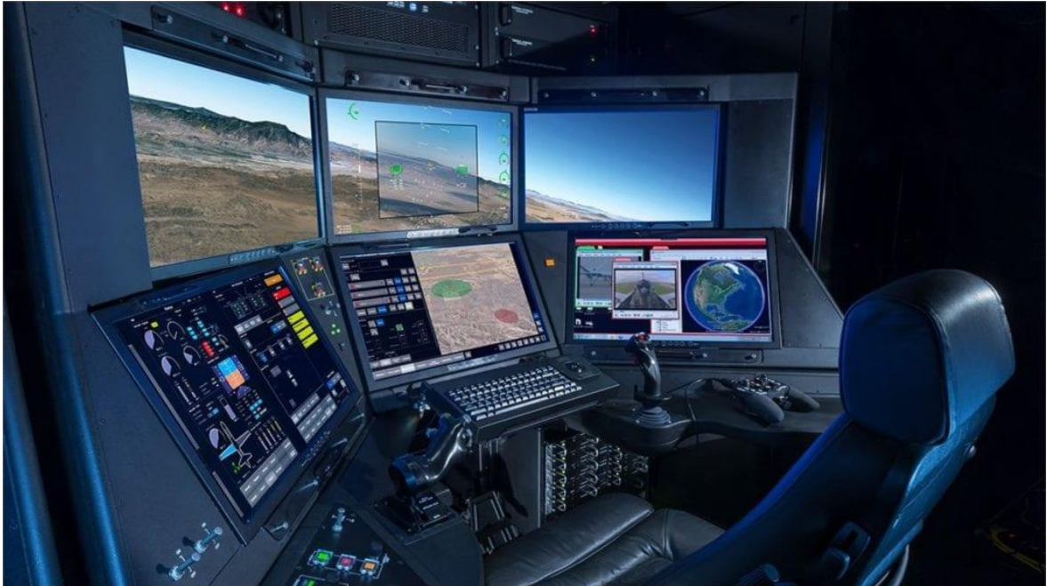
Εικόνα 2: Σταθμός ελέγχου (Ground Control Station, GCS) drone MQ-9 Reaper
