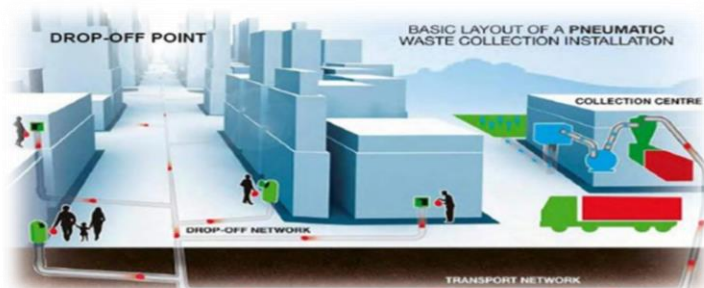
Εικόνα 19. Υπόγειο αυτόματο σύστημα μεταφοράς απορριμμάτων 44 .
