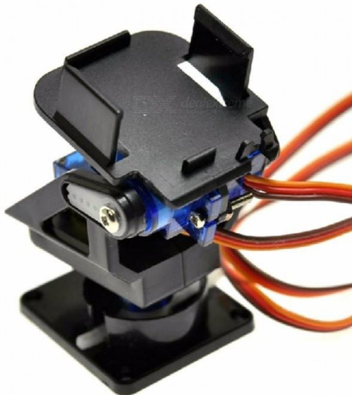
Εικόνα 6 Ο μηχανισμός κίνησης της κάμερας
