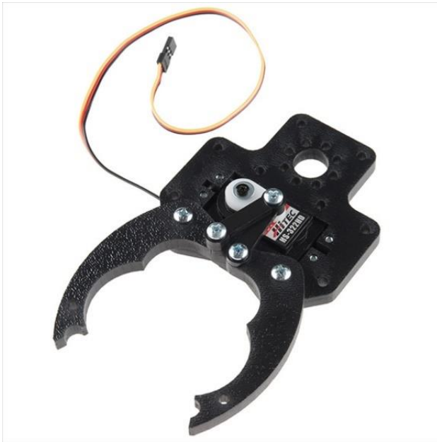
Εικόνα 5 Ο μηχανισμός δαγκάνας που χρησιμοποιήθηκε
