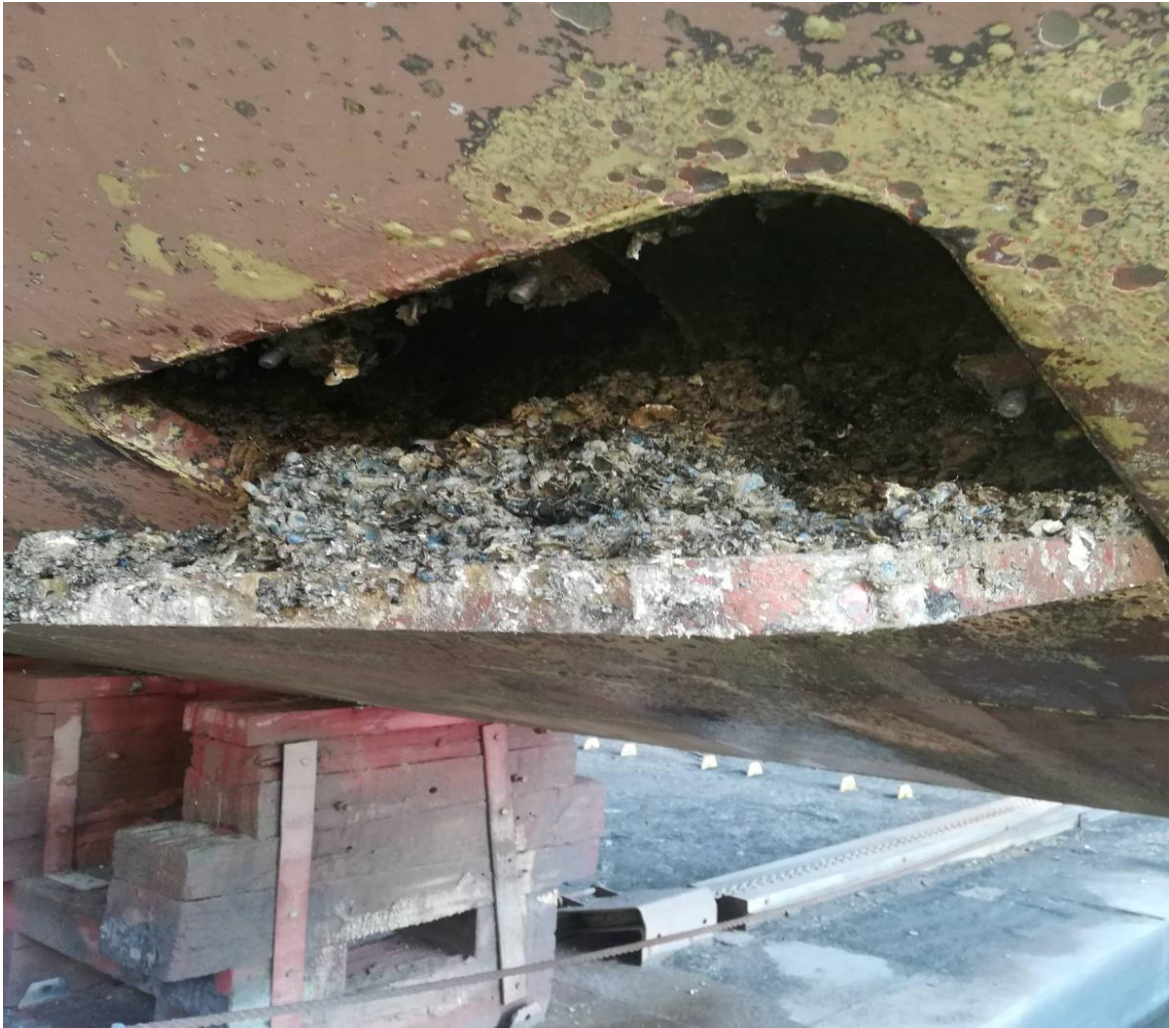
Εικόνα 5.20 : Υπερβολική ρύπανση σε αναρρόφηση γάστρας (προσωπικό αρχείο)
