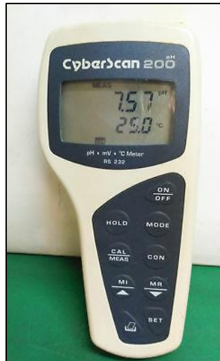
Εικόνα 17. Η συσκευή με την οποία μετρήθηκε η ηλεκτρική αγωγιμότητα (EC) Cyberscan 200 (Eutech Instruments).
