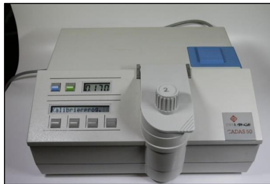
Εικόνα 18. Το μοριακό φασματοφωτόμετρο (DR LANGE CADAS 50)
