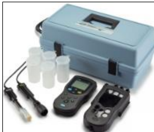
Εικόνα 19. Η συσκευή με την οποία μετρήθηκε το διαλυμένο οξυγόνο (DO) (HQ40d, Hach Instruments).
