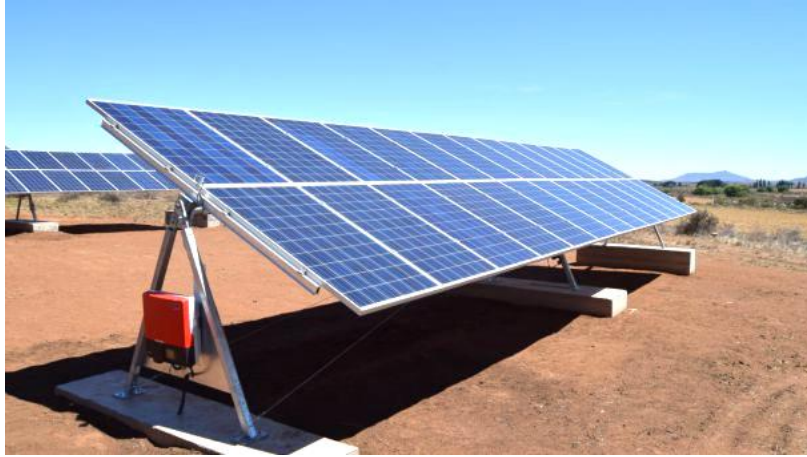
Εικόνα 2.12: Φωτοβολταϊκό πάνελ με ηλιακό ιχνηλάτη μονού οριζοντίου άξονα (Deger, 2019)
