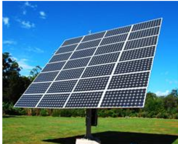
Εικόνα 2.13: Φωτοβολταϊκό πάνελ με ηλιακό ιχνηλάτη διπλού άξονα (ACES, 2019)
