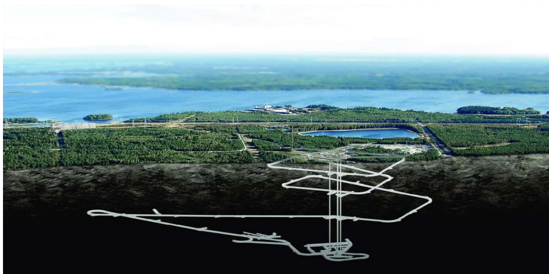
Εικόνα 7: Η εγκατάσταση μόνιμης εναπόθεσης ραδιενεργών αποβλήτων 'ONKALO' στη νήσο Oikiluoto της Φινλανδίας (Πηγή: researchgate.net)
