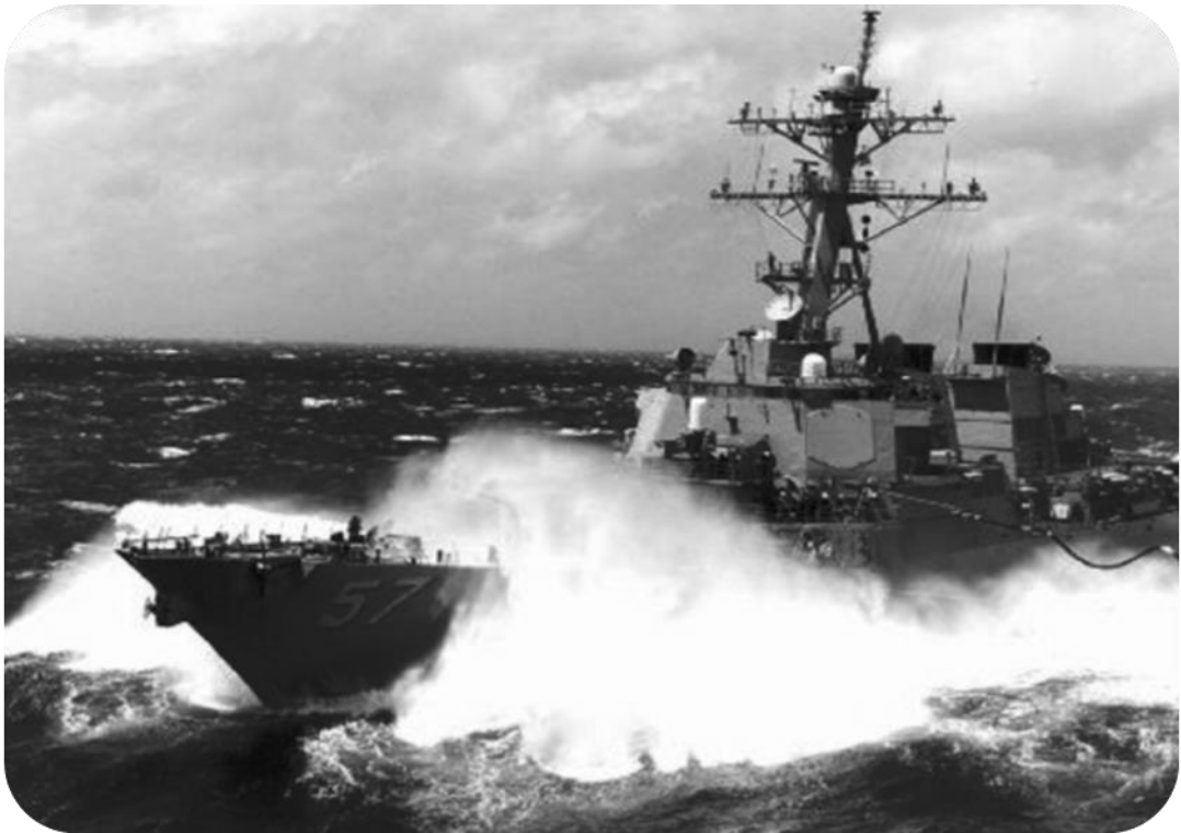
Εικόνα 8 : Πετρέλευση του US Mitchener κατά τον πλού του με ιδιαίτερα υψηλή κατάσταση θαλάσσης. ΠΗΓΗ Crenshaw, R.S., 1994, "Naval Shiphandling", (4th Edition), Md. Naval Institute Press, Annapolis
