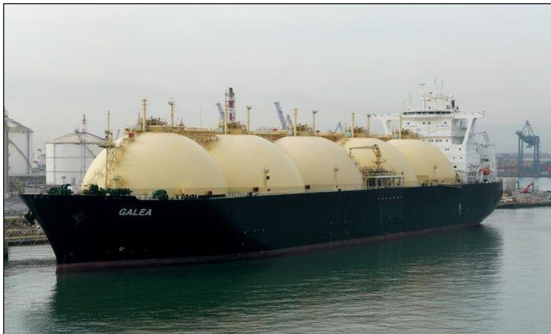
Εικόνα 4 - LNG με σφαιρική κατασκευή δεξαμενών (Πηγή: Wolfgang Meinhart/Wikimedia.org)
