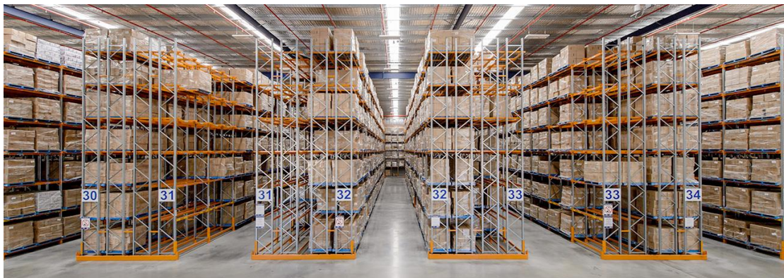
Εικόνα 7 Double depth racking
