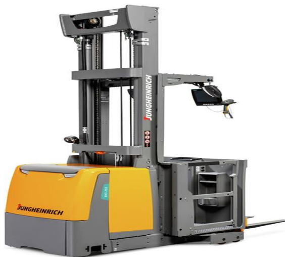
Εικόνα 25 Αυτόματο μηχάνημα συλλογής παραγγελιών 1-1,2tn
