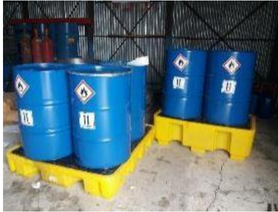
Εικόνα 19: Βαρέλια για την αποθήκευση χρησιμοποιημένων ελαίων σε εσωτερικό χώρο. Τα χρησιμοποιημένα έλαια αποστέλλονται προς ανακύκλωση δια μέσω του αντίστοιχου Συστήματος Εναλλακτικής Διαχείρισης.
