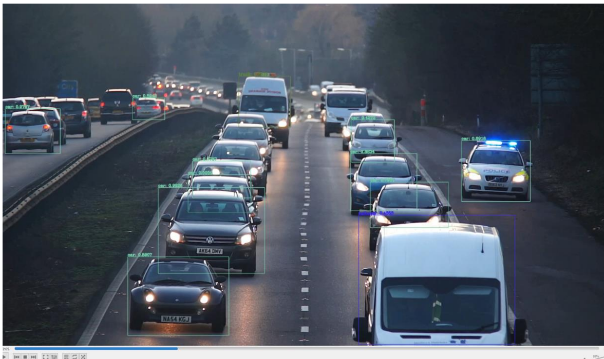
Εικόνα 62: Αποτελέσματα σε video tiny-YOLOv4
