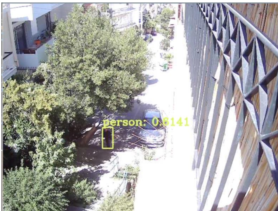
Εικόνα 90: Real-time ανίχνευση ατόμων με Raspberry
