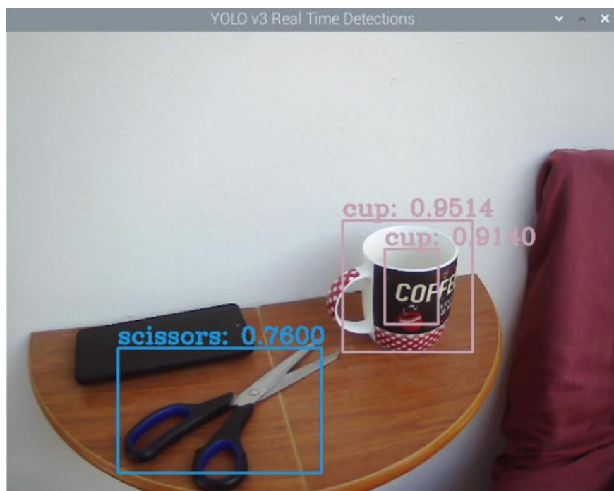
Εικόνα 84: Real-time ανίχνευση αντικειμένων με Raspberry
