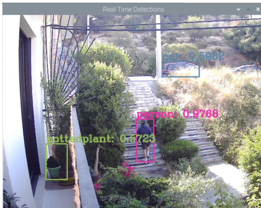
Εικόνα 87: Real-time ανίχνευση ατόμων με Raspberry
