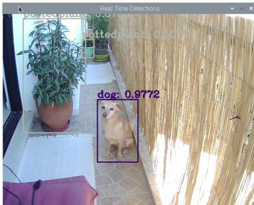
Εικόνα 86: Real-time ανίχνευση αντικειμένων με Raspberry
