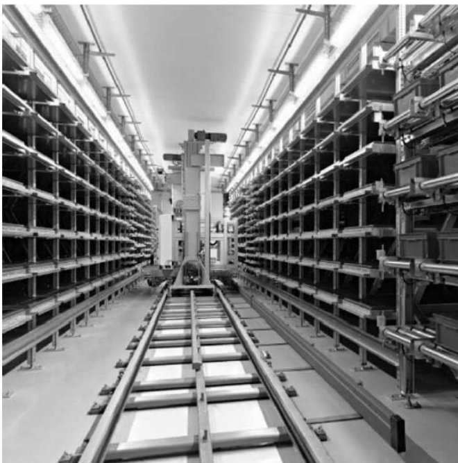
Εικόνα 20-Παράδειγμα ενός AS/RS συστήματος
