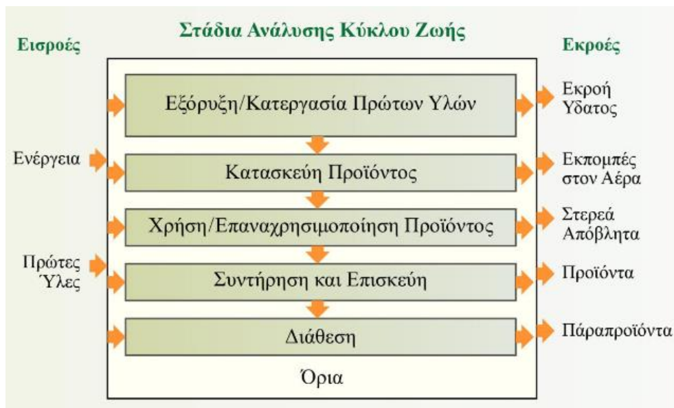
Εικόνα 107 Παράδειγμα διαγράμματος ροής ενός προϊόντος (Ζουμπούλης, et al., 2015)
