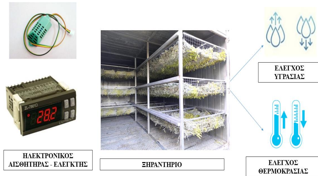
Εικόνα 40 Διαδικασία τοποθέτησης ηλεκτρονικού αισθητήρα σε ξηραντήριο τσάι του βουνού
