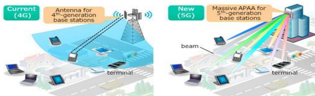
Εικόνα 10 Εξέλιξη Τεχνολογίας Πολλαπλών κεραιών 4G MIMO σε 5G MASSIVE MIMO 9
