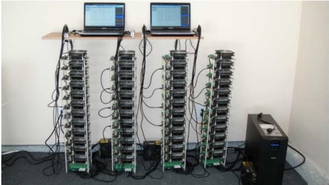
Εικόνα 12. Εξόρυξη bitcoin με τη χρήση πολλαπλών FPGAs
