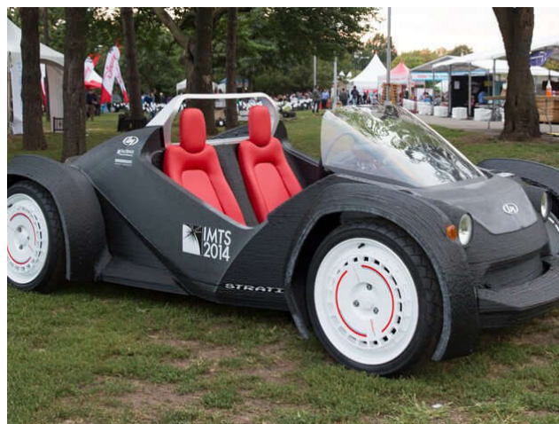
Εικόνα 3.2.: Το Strati της Local Motors, το πρώτο αυτοκίνητο 3D που τυπώθηκε από την Local Motors, χρησιμοποίησε την τεχνολογία BAAM της ORNL και παρουσιάστηκε στο IMTS το 2014
