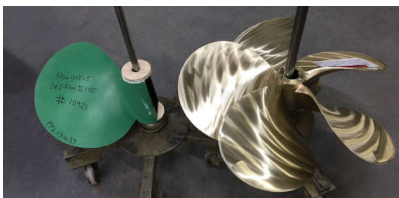
Εικόνα 3.9.: Ένας 3D τυποποιημένος τύπος πτερυγίου προπέλας και το έτοιμο τμήμα
