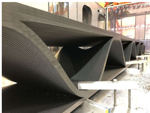
Εικόνα 3.7.: 3D-τυπωμένα εργαλεία λεπίδων για τα ελικόπτερα Bell
