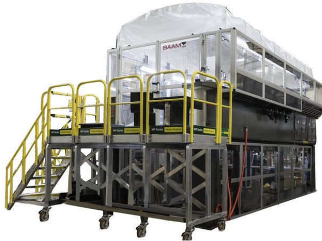
Εικόνα 3.1.: Μηχανή BAAM του Εθνικού Εργαστηρίου του Oak Ridge για την εκτύπωση μεγάλων τμημάτων πολυμερών σε 3D
