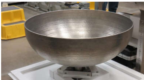
Εικόνα 3.6.: Η Lockheed Martin 3D εκτυπώνει μεγάλους θόλους τιτανίου για διαστημόπλοια χρησιμοποιώντας την τεχνολογία EBAM του Sciaky
