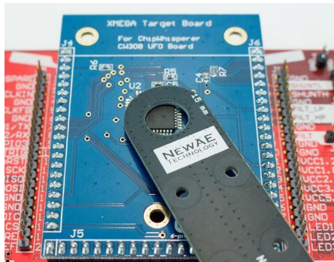
Εικόνα 37 Τοποθέτηση H-field Probe
