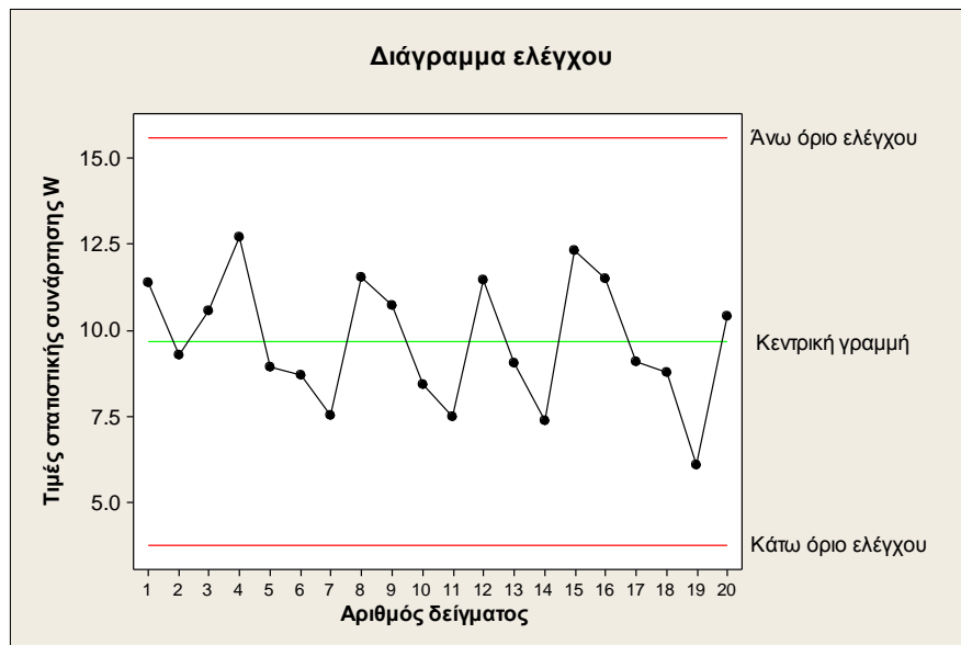
Σχήμα 1. 1. Τυπικό διάγραμμα ελέγχου Shewhart
