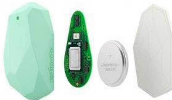
Εικόνα 8: Μηχανικά μέρη μίας συσκευής beacon (Πηγή: www.businessinsider.com )
