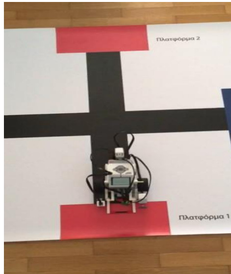
Εικόνα 27: Ανίχνευση κόκκινου χρώματος από τον αισθητήρα χρώματος
