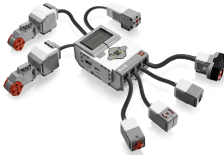
Εικόνα 9-Η συνδεσμολογία του EV3 Brick με τους κινητήρες και τους αισθητήρες
