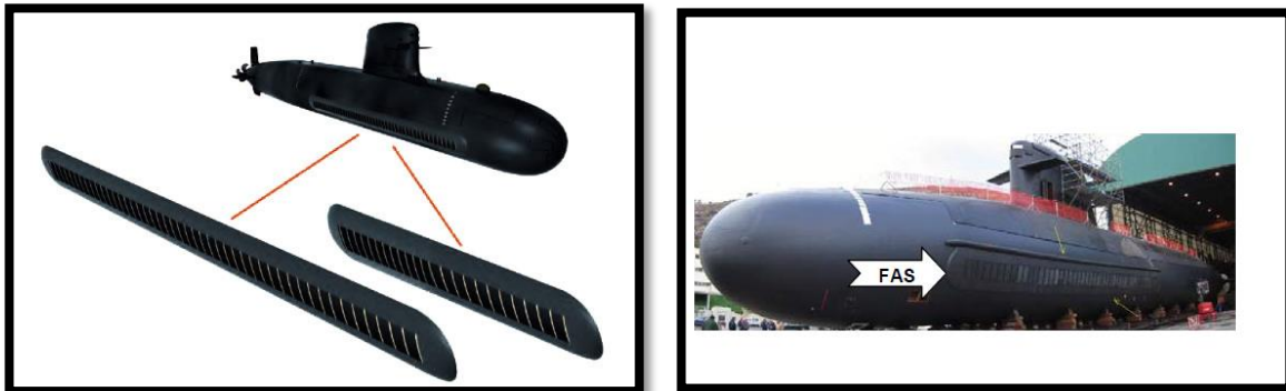
Σχήμα 1.5. Flank Array SONAR(FAS)
