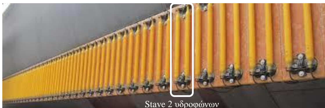
Σχήμα 1.8. Staff 2 υδροφώνων σε μία κεραία FAS
