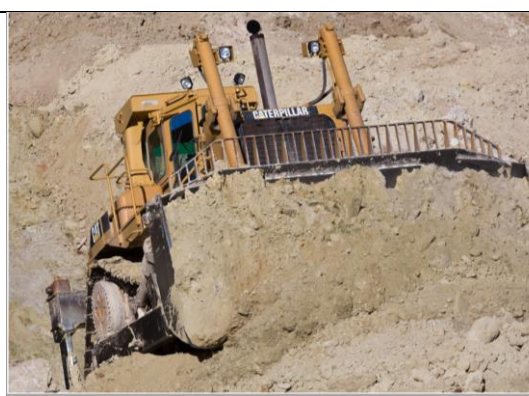
Εικόνα 24: Προωθητήρας CAT D10N
