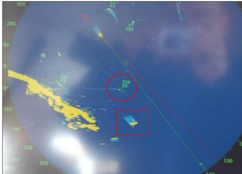
Σχήμα 4.14. Εικόνα του ραντάρ του NLV Pole Star με επικάλυψη εικόνας του συστήματος AIS επί του πλοίου όπου στο κόκκινο τετράγωνο εμφανίζεται η θέση του πλοίου υπ' αριθμόν 33458 κατά το ραντάρ ενώ στον κόκκινο κύκλο η θέση του κατά το AIS ( http://www.navnin.nl/NIN/Downloads/GLAs%20-%20GPS%20Jamming%20and%20the%20Impact%20on%20Maritime%20Navigation.pdf )
