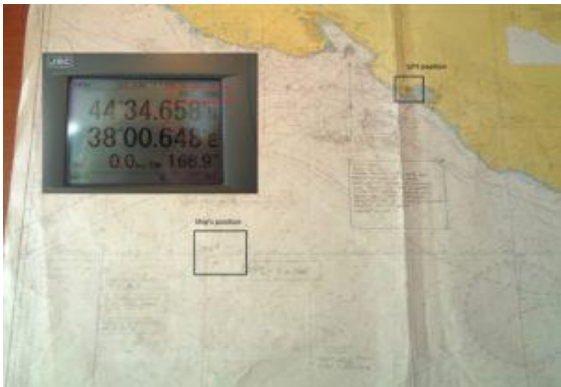
Σχήμα 4.18. Ένδειξη GPS και αντίστοιχη απεικόνιση σε έντυπο ναυτιλιακό χάρτη ( https://rntfnd.org/2017/07/12/mass-gps-spoofing-attack-in-the-black-sea-maritime-executive/ )
