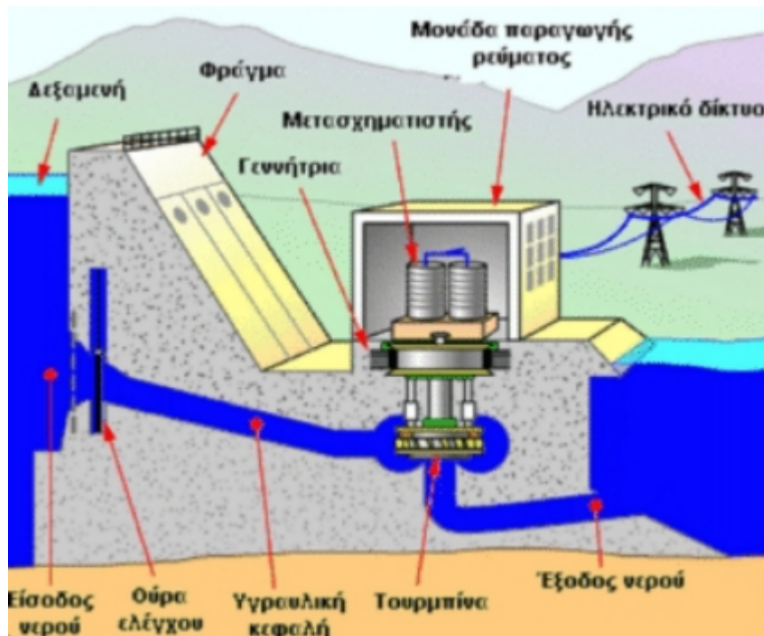
Εικόνα 4.2: Σύγχρονη διάταξη έργου παραγωγής υδροηλεκτρικής ενέργειας
