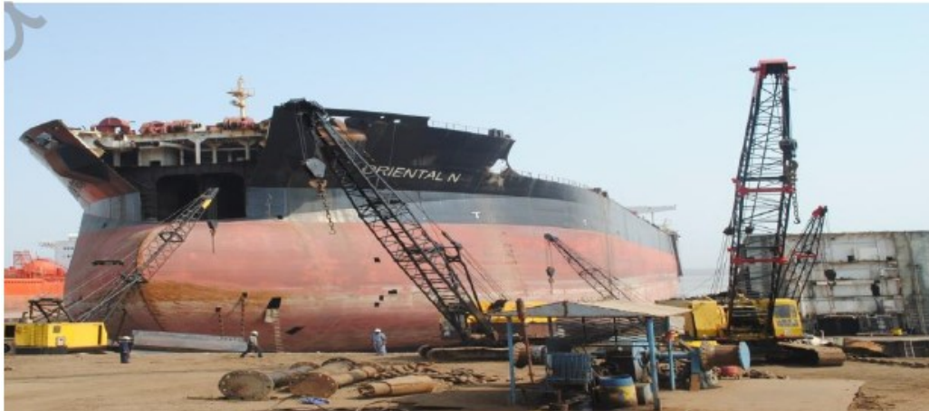
Εικόνα 2: Ξηρή μέθοδος σε δεξαμενές (Dry method ή dry dock)
