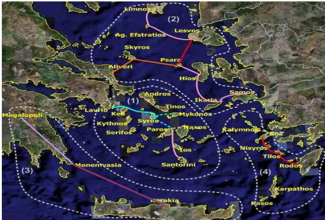
Σχήμα 2.3: Οι προτεινόμενες διασυνδέσεις νησιών του Αιγαίου κατά την «Στρατηγική Μελέτη» του ΕΜΠ. (Πηγή: «Στρατηγική μελέτη διασύνδεσης αυτόνομων νησιωτικών συστημάτων ηλεκτρικής ενέργειας - Τελική Έκθεση», ΕΠΙΣΕΥ-ΕΜΠ, 2006)
