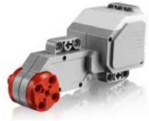
Εικόνα 13: Ο μεγάλος κινητήρας του EV3
