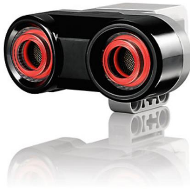
Εικόνα 19: Ο αισθητήρας υπερήχων του EV3
