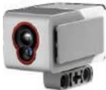
Εικόνα 15: Ο αισθητήρας χρώματος του EV3
