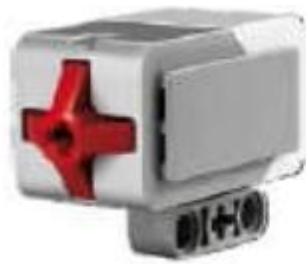
Εικόνα 17: Ο αισθητήρας αφής του EV3
