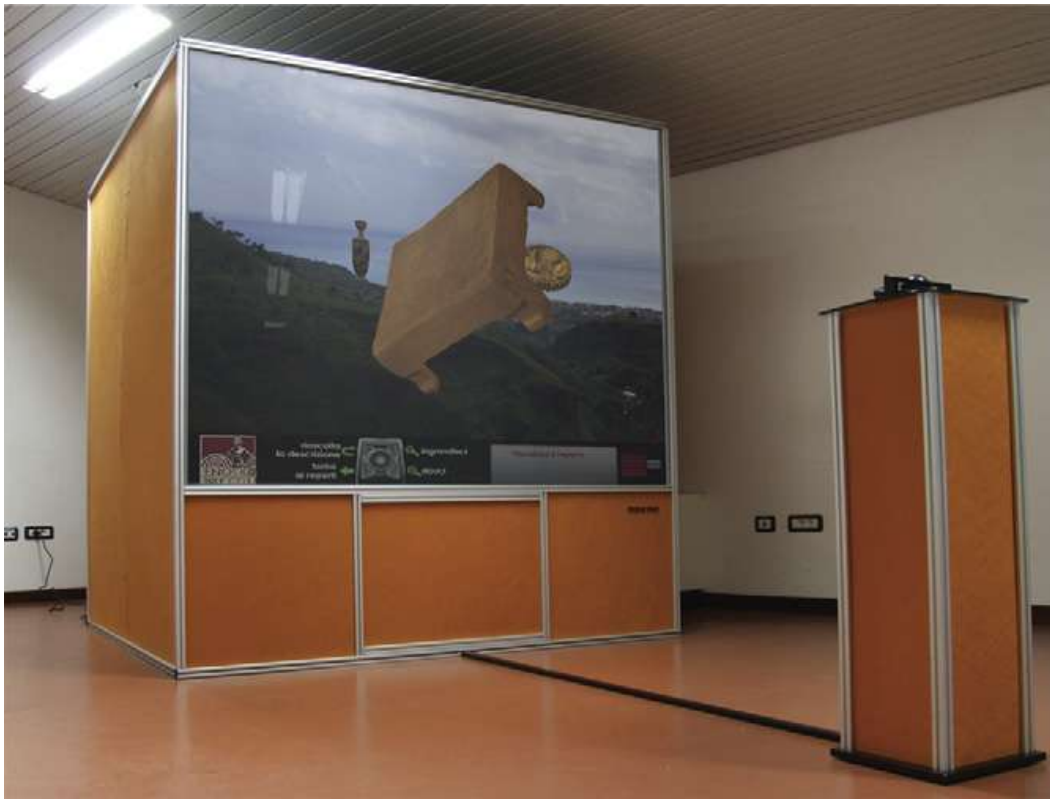
Εικόνα 15: Το πλήρες σύστημα «MNEME»: το σύστημα στερεοσκοπικής απεικόνισης, η κονσόλα εντολών και η εφαρμογή του λογισμικού.
