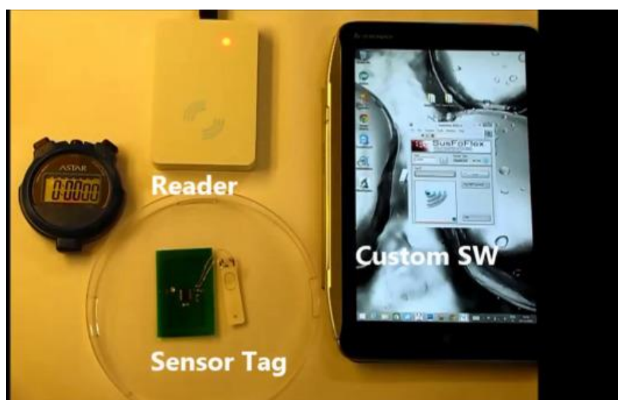
Εικόνα 6. RFID με ενσωματωμένο TTI αισθητήρα
