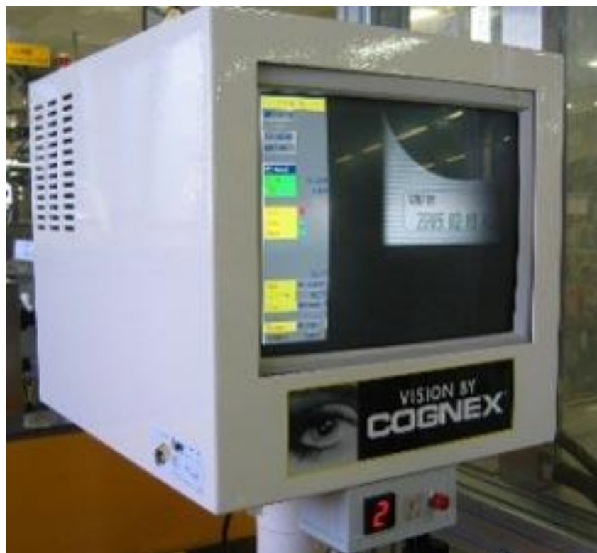
Εικόνα 15. Σύστημα οπτικού αισθητήρα για την εξασφάλιση της ανάγνωσης κώδικα και την επαλήθευση των προϊόντων ζωοτροφών τους
