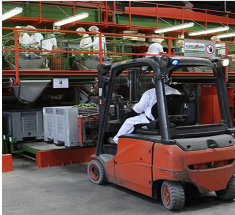
Εικόνα 14. Παράδοση πλαστικού δοχείου με αγγούρια στο σημείο αναγνώρισης από αναγνώστες γραμμικού κώδικα με βάση την εικόνα
