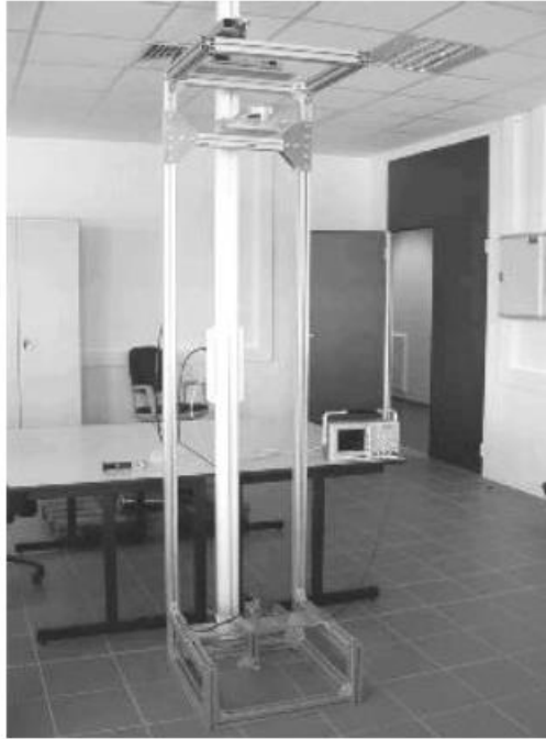
Εικόνα 5. Μετατροπέας ενέργειας βροχής με πιεζοηλεκτρικά στοιχεία
