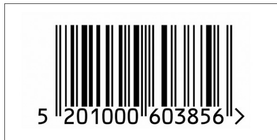
ΕΙΚΟΝΑ 2.2: ΠΑΡΑΔΕΙΓΜΑ BARCODE EAN-13
