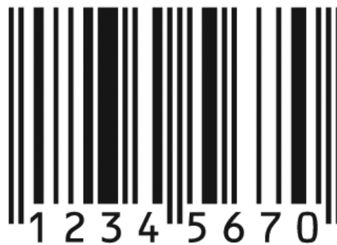
ΕΙΚΟΝΑ 2.2: ΠΑΡΑΔΕΙΓΜΑ BARCODE EAN-13
