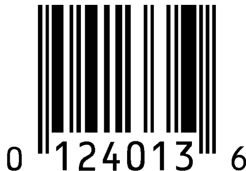
ΕΙΚΟΝΑ 2.4: ΠΑΡΑΔΕΙΓΜΑ BARCODE UPC-A
