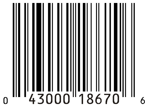
ΕΙΚΟΝΑ 2.4: ΠΑΡΑΔΕΙΓΜΑ BARCODE UPC-A
