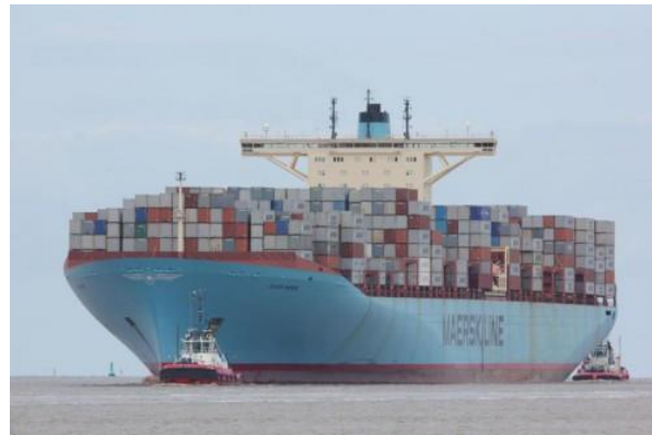
Σχήμα 3. Ένα σύγχρονο πλοίο μεταφοράς εμπορευματοκιβωτίων. Στην εικόνα φαίνεται το Eugen Maersk, έχει μήκος 400 μέτρα και πλάτος 56 μέτρα. Ένα από τα πιο σημαντικά πλεονεκτήματά του είναι η δυνατότητά του να μεταφέρει 15.500 containers.
