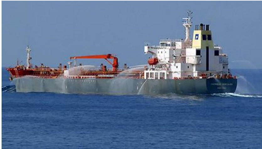
Εικόνα 9: Πυροσβεστικοί Σωλνες. [Marine Insight]
